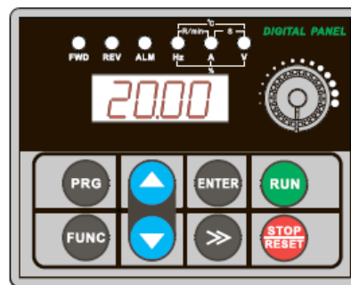
Дисплей в режиме вращения (Отображение выходного тока "20.00")
