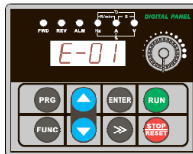
Отображение ошибки "Перегрузка по току при ускорении"
